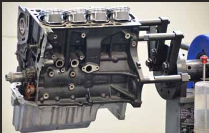
Revisie van een TSI-motor, klaar voor montage van de zuigers
